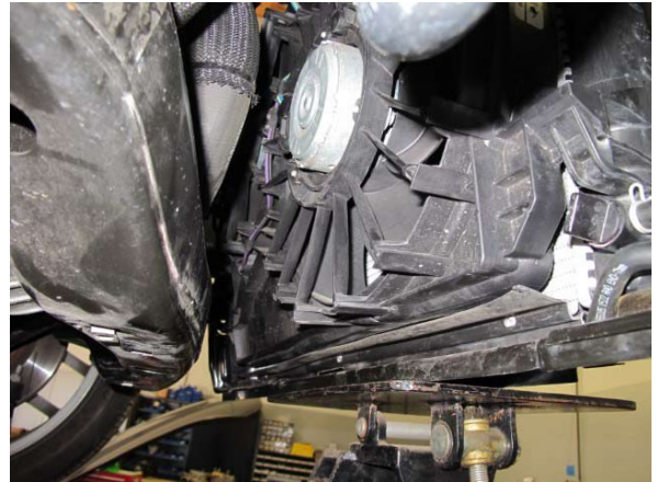
Fig. 2-v: Remove radiator fan assembly
