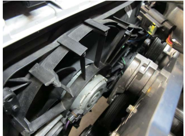
Fig. 2-s: Remove radiator fan assembly
