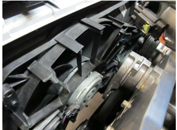
Fig. 4-a: Reinstall radiator fan assembly
