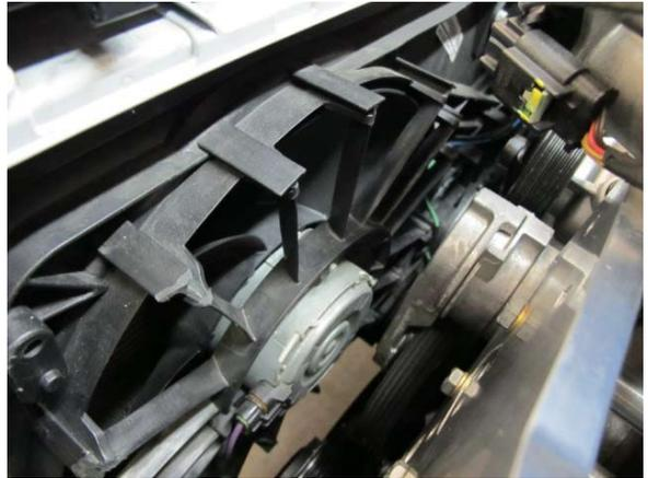
Fig. 4-a: Reinstall radiator fan assembly
