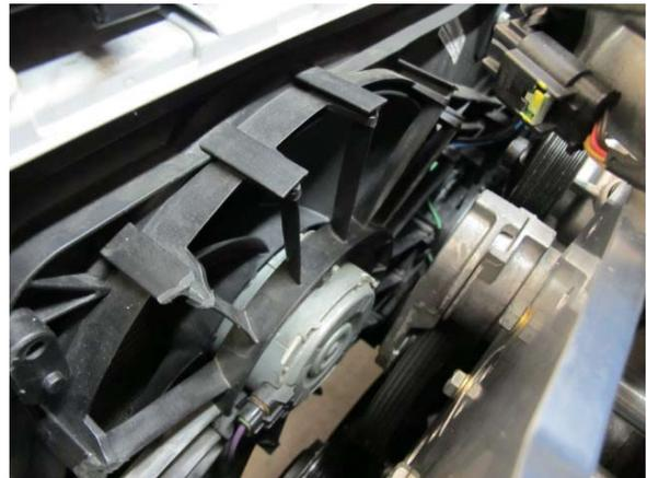
Fig. 2-n: Remove radiator fan assembly
