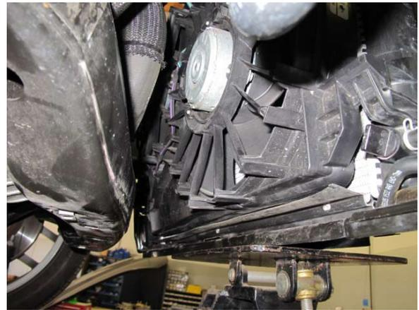
Fig. 2-q: Remove radiator fan assembly
